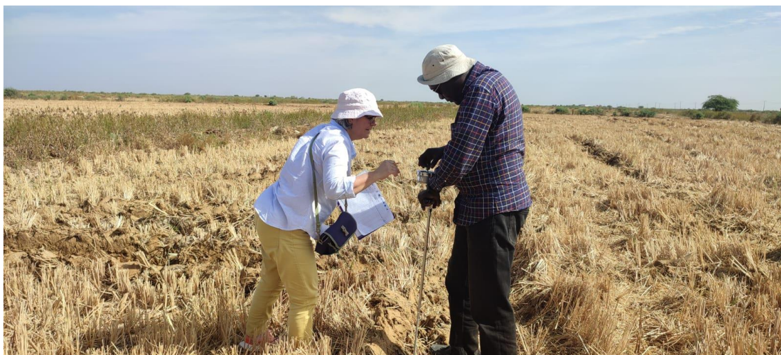
Figure 7: Collecte de données sur la résistance à la pénétration sur les parcelles du GEI de Ross-Béthio. Source : Élaboration propre.
