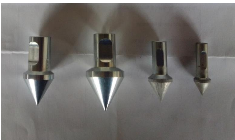
Figure 3 : Jeu de cônes du pénétromètre Eijkelkamp. Source : Élaboration propre.
