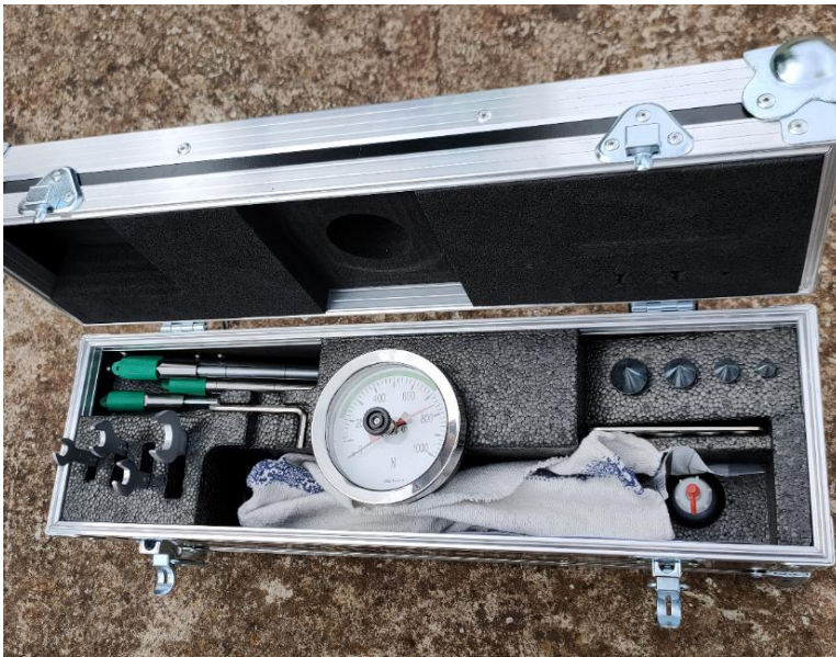
Figura 2: Penetrómetro de la marca Eijkelkamp, de accionamiento manual. Fuente: Elaboración propia.
