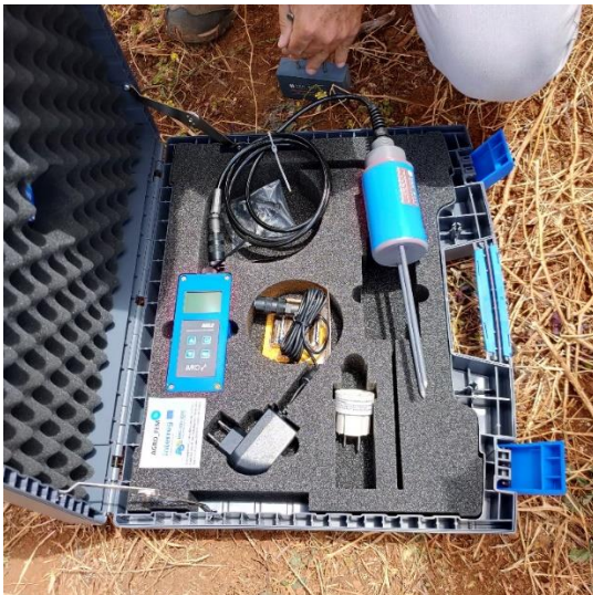
Figura 4: Sonda de la marca IMKO TRIME-PICO 64/32. Fuente: Elaboración propia.
